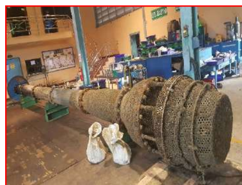
ภาพที่ 2.2-19 ตะแกรงกรองขนาด 16 มิลลิเมตร ที่หัวเครื่องสูบน้ำทะเล
