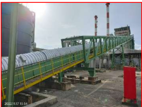
ภาพที่ 2.2-7 อุปกรณ์ปิดครอบสายพานลำเลียงอย่าง มิดชิด
